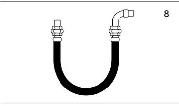
8  | Durch falschen Einbau der Metallschläuche entsteht eine <b>starke Biegebeanspruchung</b> hinter den Anschlüssen (7, 9, 11, 13, 15). Durch Anbringen von Rohrbogen vermeidet man diese Fehler (8, 10, 12).                                                                                                                                              |
