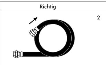
2    | In aufgerolltem Zustand entsteht durch <b>Ziehen an den Enden</b> eine für Metallschläuche schädliche <b>Torsionsbeanspruchung</b> , und der kleinste zulässige Biegeradius wird unterschritten (1+3). Durch <b>richtiges Auf- und Abrollen</b> wird dieser Fehler vermieden (2+4).                                                                    |
