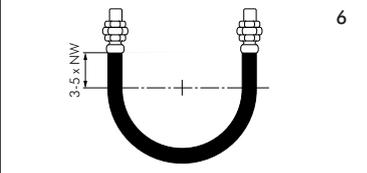
6  | Durch Verwendung einer zu <b>kleinen Länge</b> wird der Metallschlauch an den Anschlussstellen abgeknickt (5). Der aus dem zulässigen Biegeradius errechneten Länge ist pro Anschlussseite ein gerades Stück von 3-5x NW zuzuschlagen (6). Durch die Wahl eines größeren Biegeradius als dem kleinstzulässigen erhöht sich die Lebensdauer wesentlich. |
